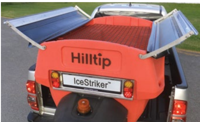
Le système de bâche et grille
