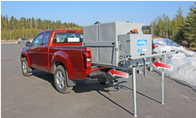
Béquilles réglables en hauteur pour un montage et démontage facile de la saumureuse.
