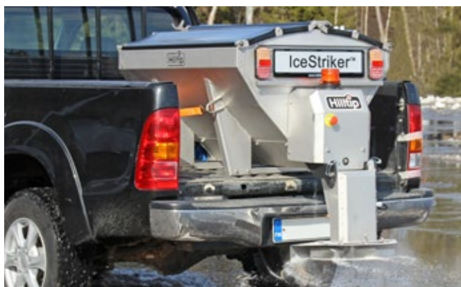
Largeur d'épandage de jusqu'à 8 mètres
