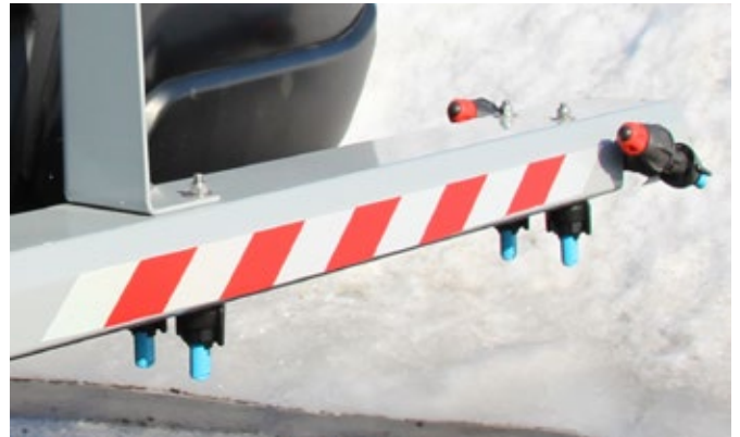
Doubles rangées de buses de pulvérisation pour un dégivrage homogène à haute vitesse.
