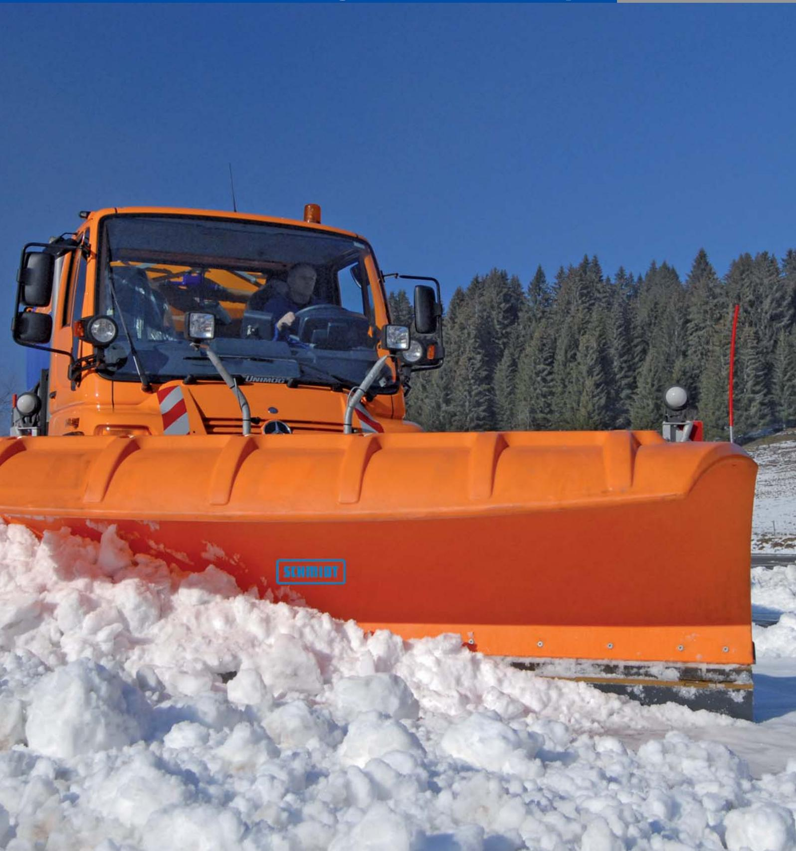
Les lames légères de la série SNK équipées d'un corps de lame en matière plastique sont conçues pour l'évacuation de neige peu abondante en basse altitude. Elles sont simples d'utilisation et idéales pour l'évacuation de neige fondante ou de restes de neige.
