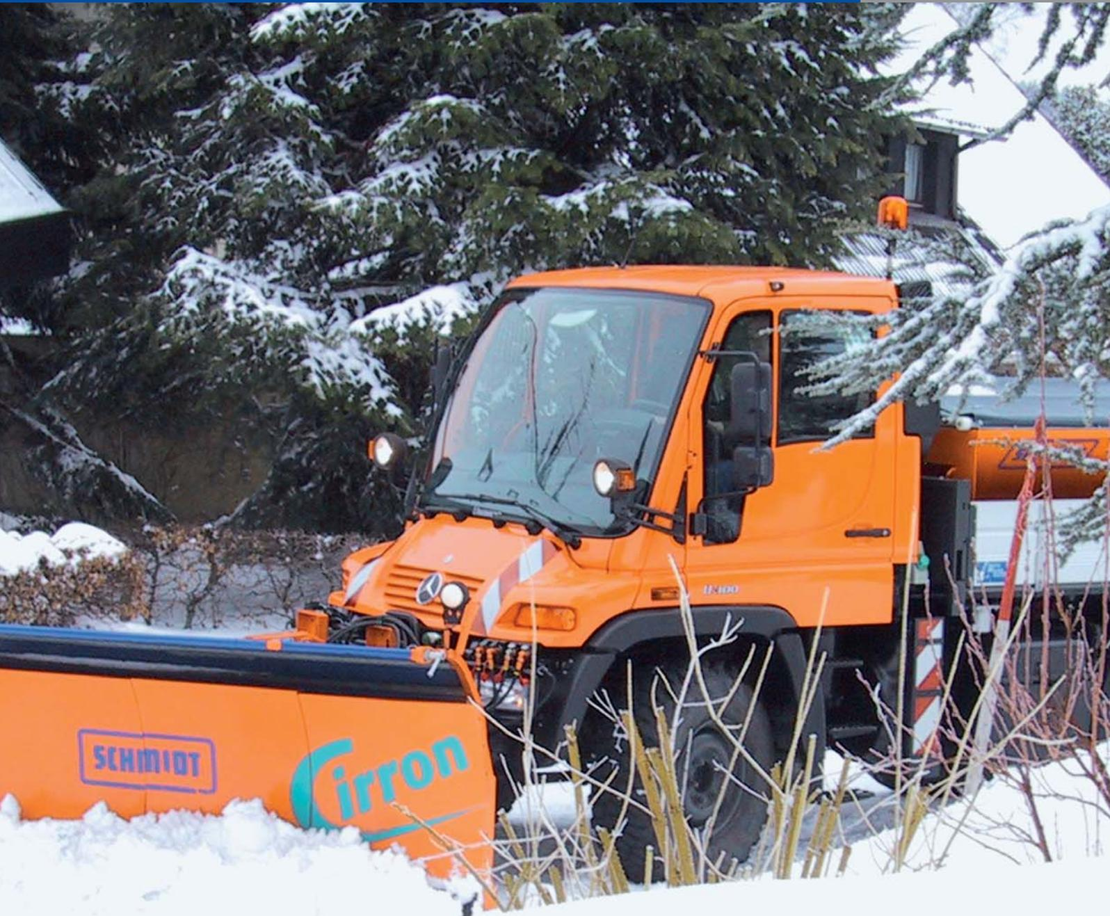
Les lames de déneigement à panneaux de la série Cirron sont équipées d'un système de franchissement d'obstacle breveté et sont conçues pour répondre aux exigences du déneigement en moyenne montagne, même quand la neige est abondante. Elles sont robustes et s'adaptent à la surface de la chaussée.
